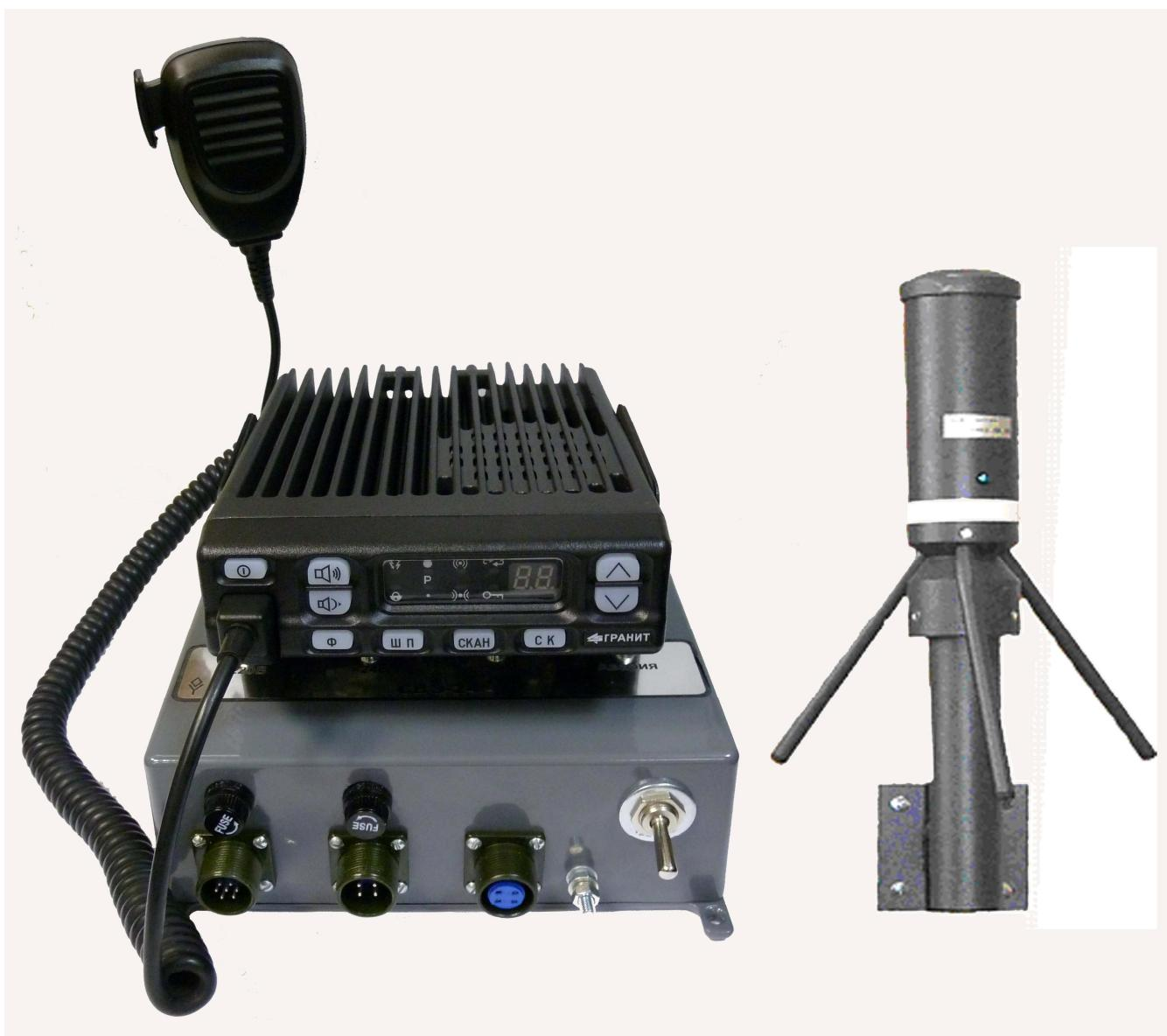
**Рисунок А.1- Внешний вид радиостанции в возимом исполнении**
