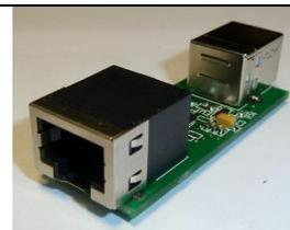
Адаптер соединяется с USB-портом компьютера при помощи стандартного кабеля «USB тип А – USB тип В».
