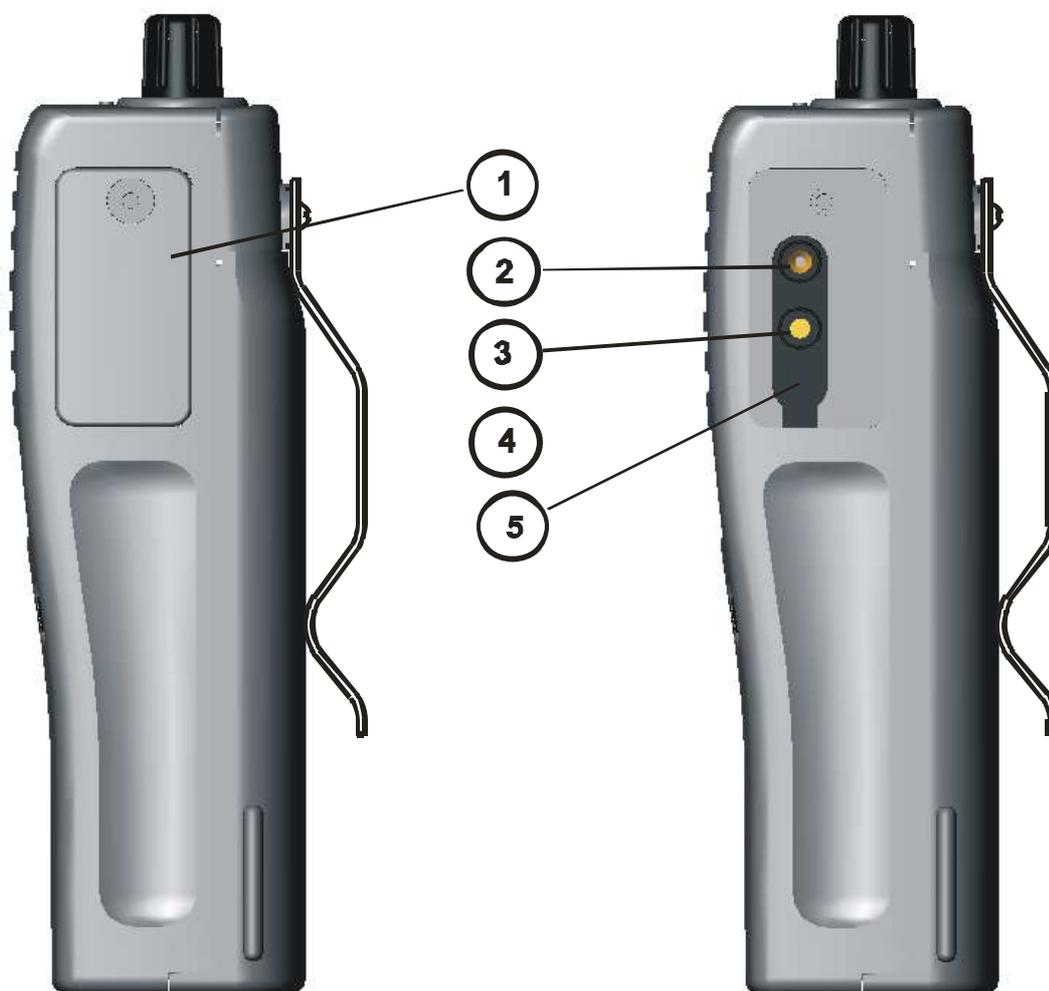
1- защитная крышка соединителей; 2 – соединитель для подключения внешнего громкоговорителя; 3- соединитель для подключения внешнего микрофона; 4- зажим поясной; 5 – ИК-порт для программирования с ПЭВМ
