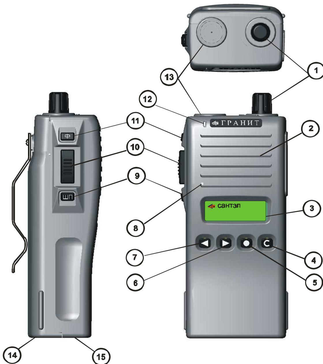
1-ручка включения/выключения радиостанции и регулирования уровня громкости; 2- встроенный громкоговоритель; 3- экран жидкокристаллический; 4-7,11 – функциональные кнопки; 8- встроенный микрофон; 9- кнопка включения/выключения шумоподавителя; 10- кнопка включения режима «Передача»; 12- индикатор световой; 13- антенный соединитель; 14- батарея аккумуляторная; 15- замок крепления батареи аккумуляторной
